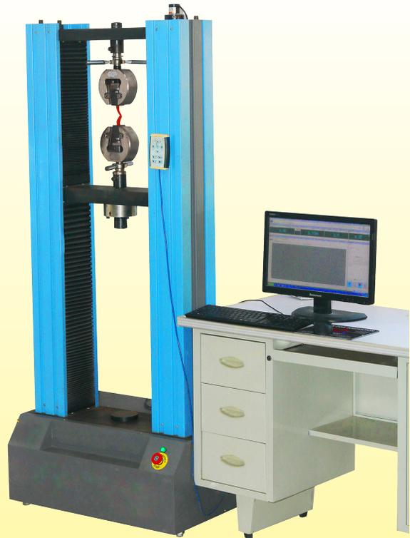
Equipement d'essai à la résistance au déchirement
