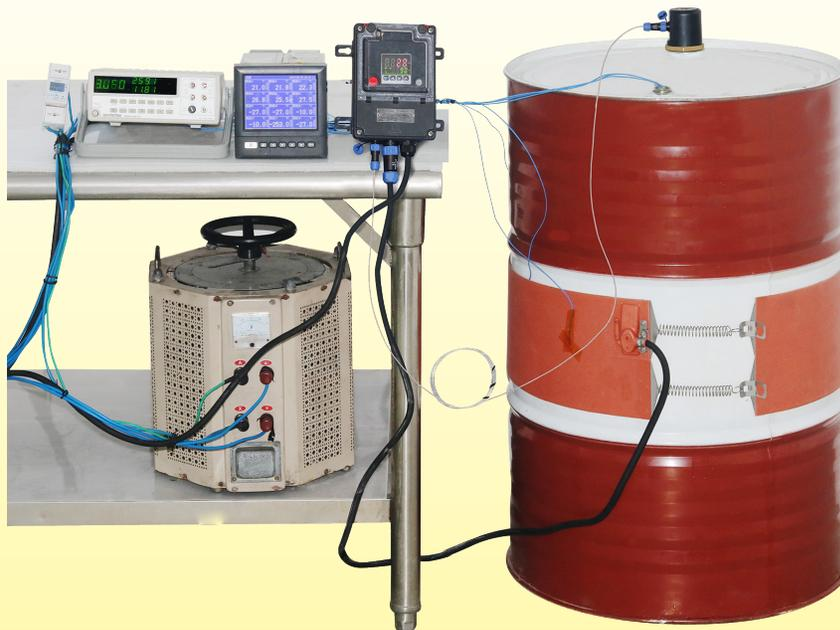
Variation de la température dans le temps de la température d'un fût métallique de 220 litres, rempli d'eau, réchauffé par une ceinture chauffante silicone de largeur 200mm, sans isolation thermique, de puissance 2250W (charge surfacique 0.75W/cm<sup>2</sup>).
