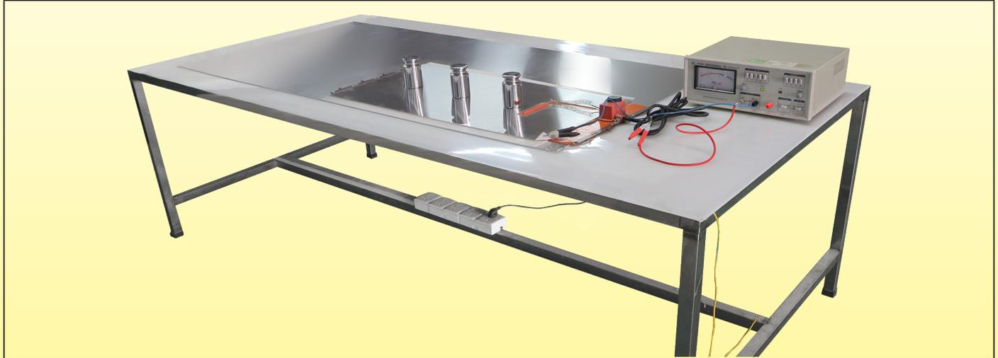
Dispositif de mesure de la résistance d'isolement.
