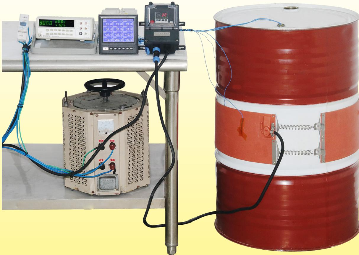
Variation de la température dans le temps de la température d'un fût métallique de 220 litres, rempli d'eau, réchauffé par une ceinture chauffante silicone de largeur 200mm, sans isolation thermique, de puissance 1500W (charge surfacique 0.5W/cm<sup>2</sup>).
